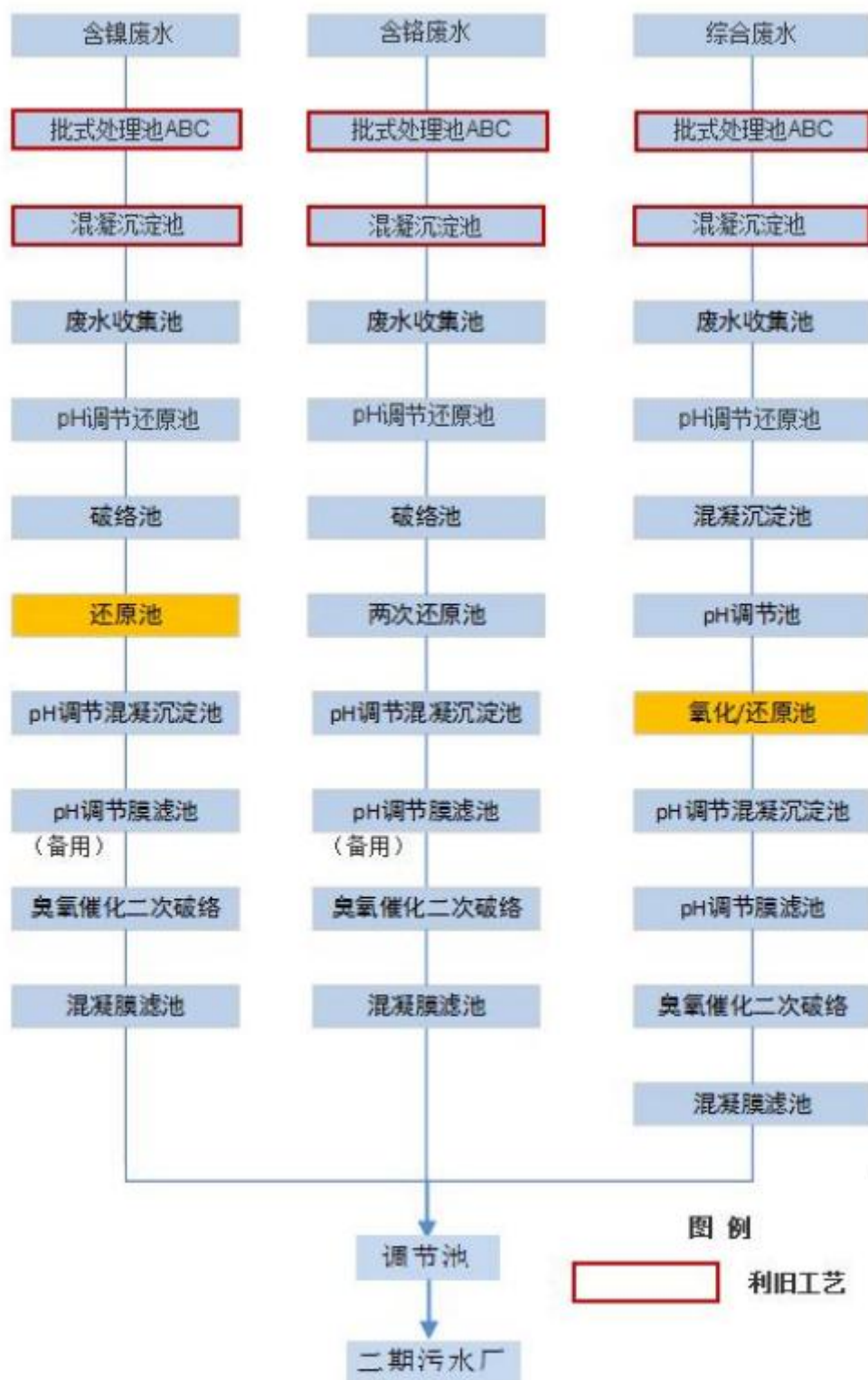
图 5.1-1 一期工程废水处理系统工艺流程图
