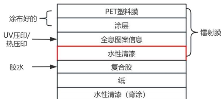
图2-2 产品结构图（雷射纸）
