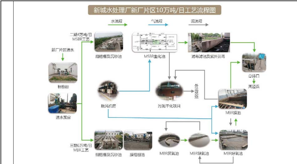
图 4-9 新城水处理厂二期、三期工艺流程图
