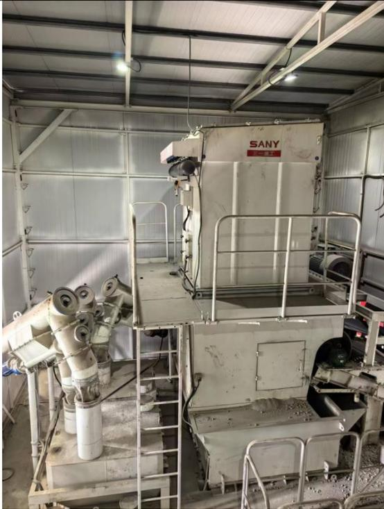
主机高效脉冲除尘+喷淋系统(上料混合搅拌)
