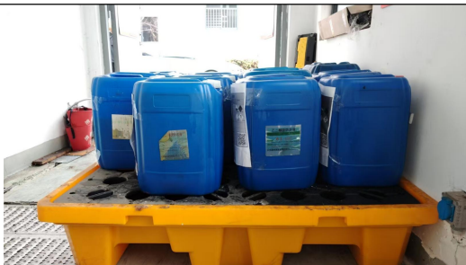
危废仓库防泄漏托盘
