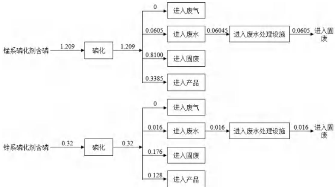
图 2-2 本项目磷元素平衡图 (t/a)
