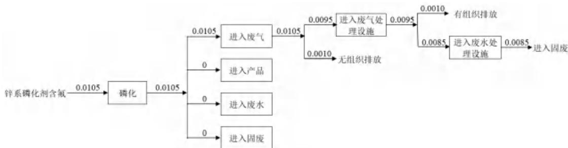
图 2-5 本项目氟元素平衡图 (t/a)
