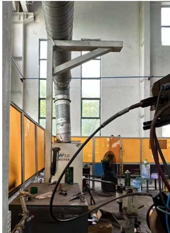
图 3-5 移动式焊烟除尘器
