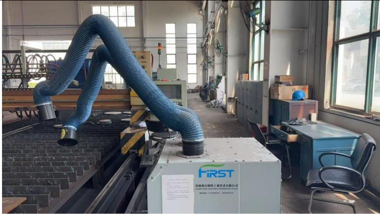
图 3-4 移动式烟尘净化器
