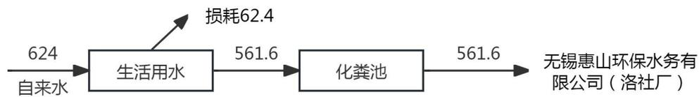
图 2-1 本项目水量平衡图（单位：t/a）
